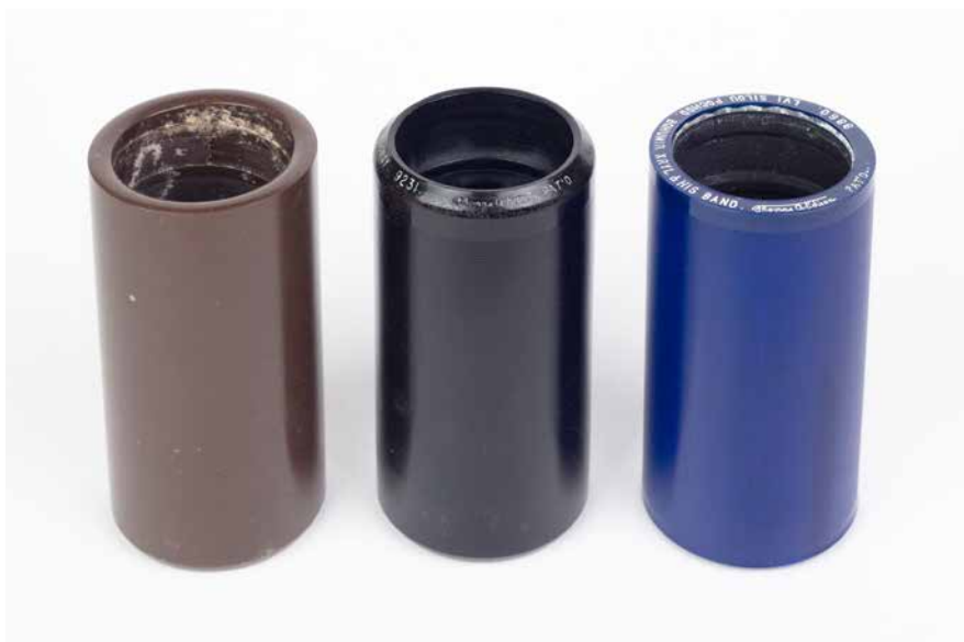
Obr. 1. Nejčastěji dochované typy fonografických válečků – voskové válečky (hnědý a černý) a celulooidový váleček (série Blue Amberol).
